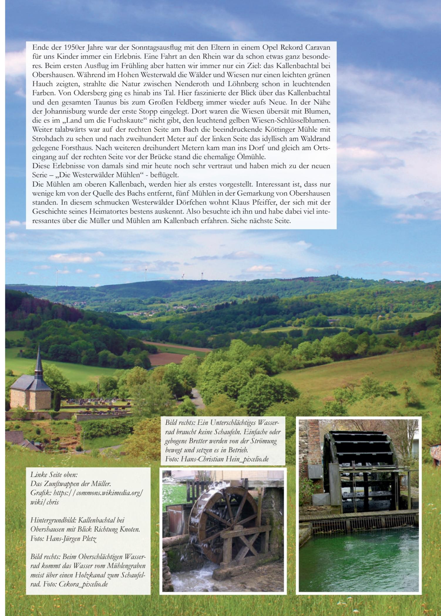
Bild rechts: Ein Unterschlächtiges Wasserrad braucht keine Schaufeln. Einfache oder gebogene Bretter werden von der Strömung bewegt und setzen es in Betrieb.
